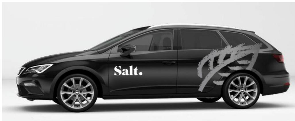
*Oben eine Darstellung des Hybridmodells Seat Leon 1.4 TGI EcoFuel, das sowohl über einen Benzin- als auch einen Erdgas-/Biogasantrieb verfügt. Die neue Firmenwagenflotte von Salt wird künftig grossmehrheitlich aus solchen Hybridfahrzeugen bestehen.*
